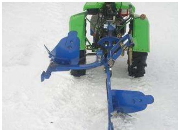
Slika 2. Obrtni plug za jednoosovinske traktore
